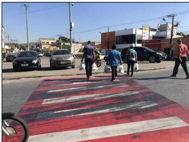
**Figura 01** – Registro fotográfico da Praça Getúlio Vargas: ausência de rebaixo de pedestres, ausência de demarcação de vagas de veículos e calçadas.
